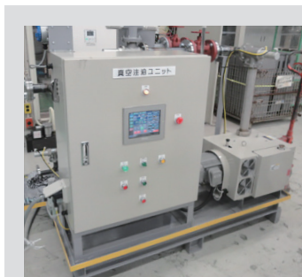
トランス真空注油ユニット
